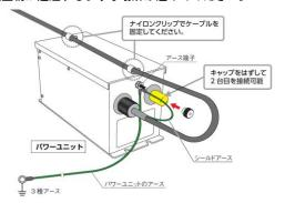
④高圧ケーブルを付属のナイロンクリップを使用してGP-1の蓋に固定してください。高圧コネクタ部に引っ張り等のテンションがかかることを防ぎます。
