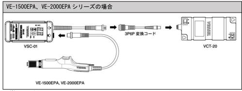
※ 3P6P 変換コードは VE-1500EPA, VE-2000EPA 本体に付属しています。
