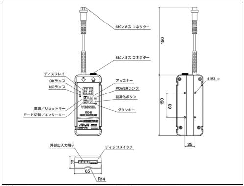
※1 ネジ長 12mm以上のネジで固定すると基盤を破損することがあります。
